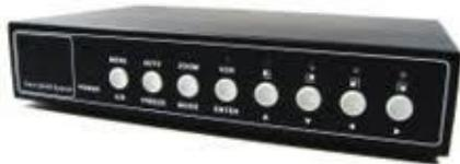
En algunos casos estos multiplexores tienen entradas/salidas de alarmas permitiendo la generación y el tratamiento de eventos de una forma limitada. Por ejemplo ante una alarma, como la generada por un sensor de humo o gas, mostrar siempre una determinada cámara en los monitores y emitir una señal acústica ó generar a partir del movimiento detectado en una determinada región, señal transmitida por la cámara
