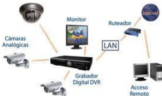
Los grabadores digitales, permiten almacenar y/o distribuir en formato informático imágenes y sonido de manera segura y eficaz; además permiten la transmisión, por ejemplo, mediante líneas de alta velocidad de la información generada por los dispositivos.
